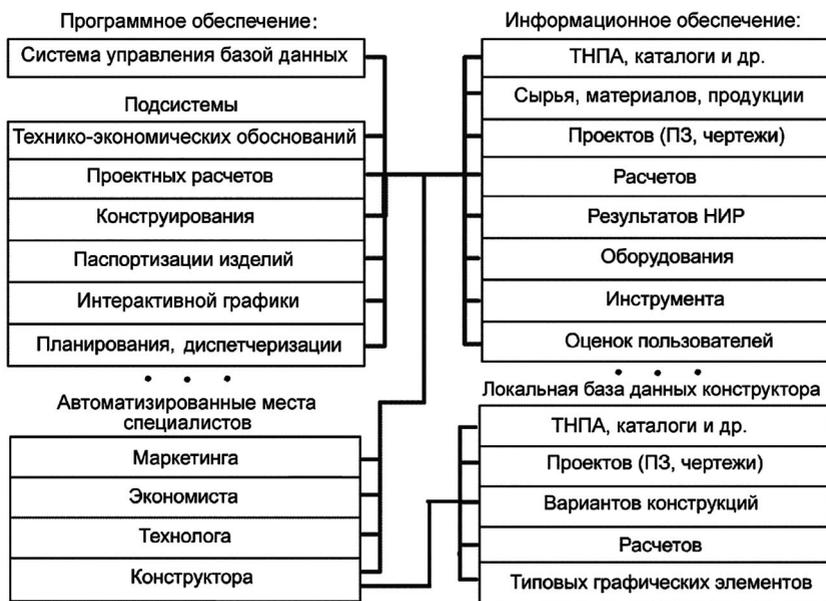
Рис. 1. Схема информационных связей САПР конструктора изделия
